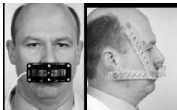
Rys. 3. Mocowanie zbioru znaczników diodowych [9].
