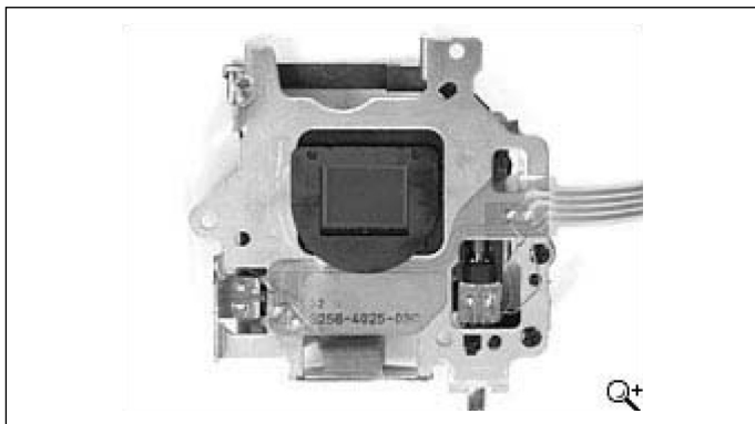
Ryc. 3. System Anti-shake wbudowany w aparatach Konica Minolta DiMAGE A2.
